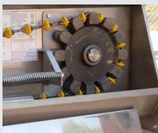
Sistema de reparto de pienso combinado, mediante transporte por espiral desde el silo a los circuitos de cadena.
