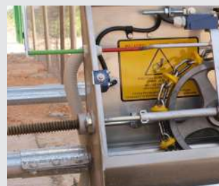
Sistema de reparto de pienso combinado, mediante transporte por espiral desde el silo a los circuitos de cadena.
