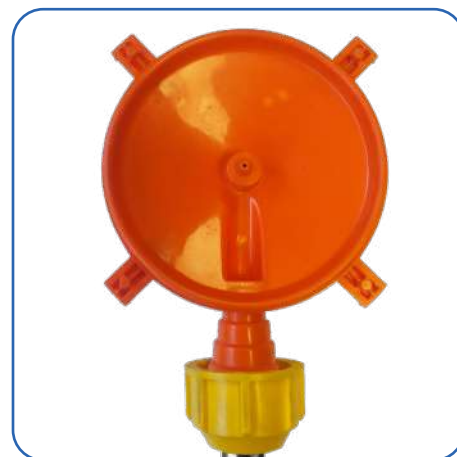
PASO 6 : Cuerpo de la válvula sin tapa y sin membrana.
