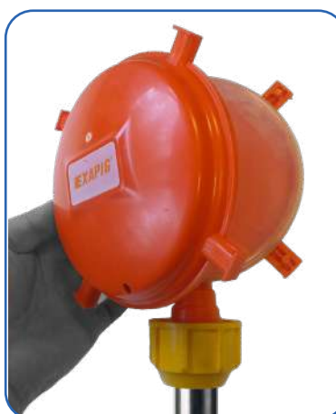
PASO 8: Tapa colocada encima de la membrana.
