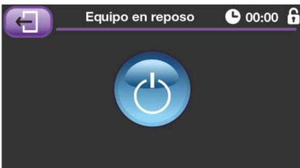
En el estado de reposo el equipo no realiza ningún tipo de acción externa, es decir, se siguen realizando operaciones de lectura de sondas, cálculos, etc., pero todas las salidas permanecen en estado de reposo y el relé de alarma permanece siempre activo para no provocar falsas alarmas en la explotación.
