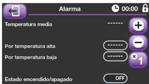
En esta pantalla podemos programar los datos de la alarma. Tenemos dos temperaturas a programar, una para el control del exceso de temperatura y otra para la falta de la misma.
