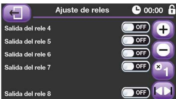
Ésta es la pantalla de pruebas de las salidas digitales, al igual que en el caso anterior, podemos programar las salidas a nuestro antojo, para poder realizar pruebas de funcionamiento del equipo o sus periféricos.
