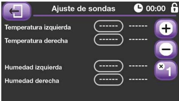
Aquí se nos permite ajustar las sondas de temperatura y humedad al valor de un aparato de medida de nuestra confianza.
