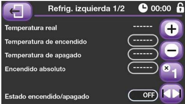
En estas pantallas nos aparecen los datos de trabajo programados para el control de las refrigeraciones, aquí podremos programar la temperatura de encendido (por encima de ella el sistema de refrigeración empieza a funcionar) y la temperatura de apagado (por debajo de ella la refrigeración permanecerá siempre apagada).
