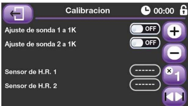
Mediante la pantalla de Calibración de sensores se ofrece la posibilidad tanto de recalibrar las sondas de temperatura con un ajuste de 1K (proceso que se iniciará al pulsar cualquiera de los interruptores deslizantes de la primera y segunda línea, por lo cual será necesario tener conectada la sonda de calibración de 1K).
