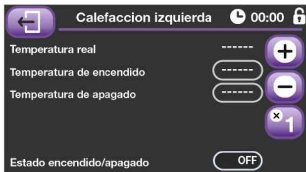
En estas pantallas nos aparecen los datos de trabajo programados para el control de las calefacciones, aquí podremos programar tanto la temperatura de conexión (por debajo de ella la calefacción permanecerá encendida), como la temperatura de desconexión (por encima de ella la calefacción permanecerá siempre apagada).
